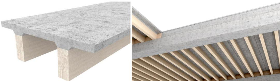
Figura 2. Izquierda: Imagen 3D de un módulo mixto madera-hormigón. Derecha: Ejemplo de forjado modular.
