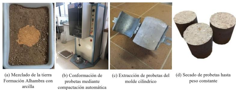
Figura 1. Proceso de conformación de probetas de tierra.
