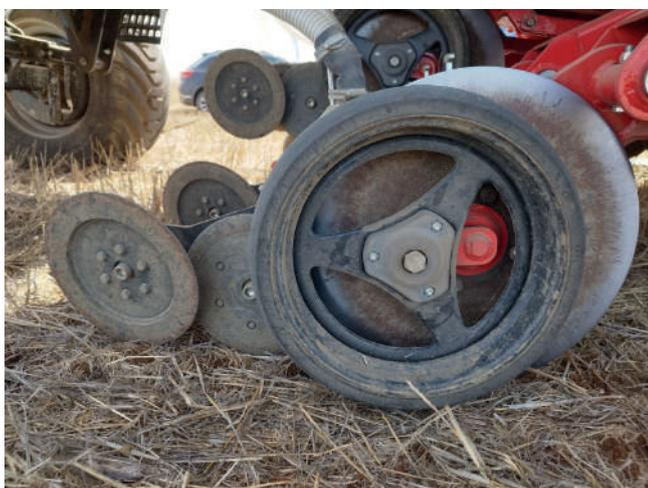
**Figura 3.** Sembradora directa monodisco de cereal
